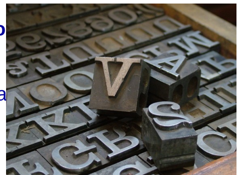
I caratteri mobili vengono messi uno accanto all'altro per formare le parole
